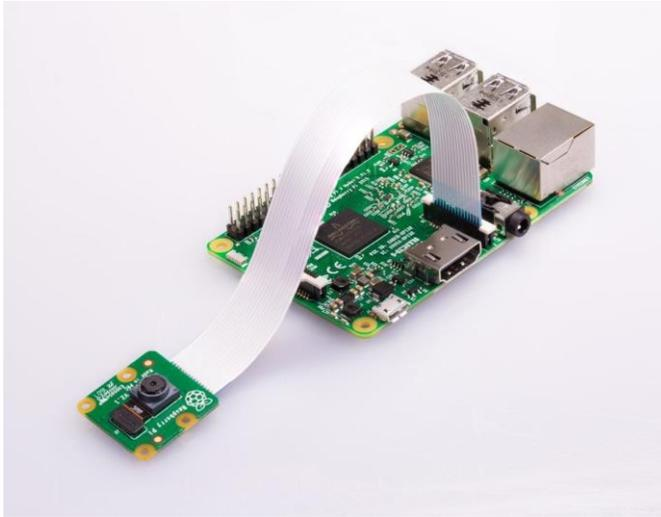
Fig. 3. Raspberry Pi module
