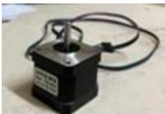
Fig. 8. Nema 17 stepper motor
