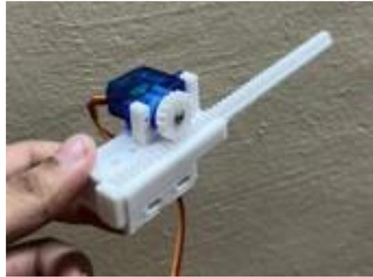
Fig. 9. Linear actuator
